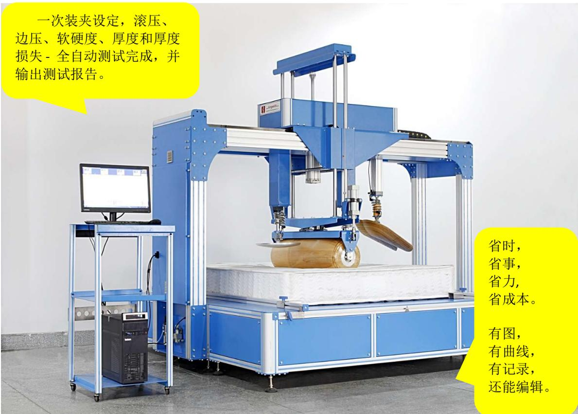
一次装夹设定，滚压、边压、软硬度、厚度和厚度损失 - 全自动测试完成，并输出测试报告。
