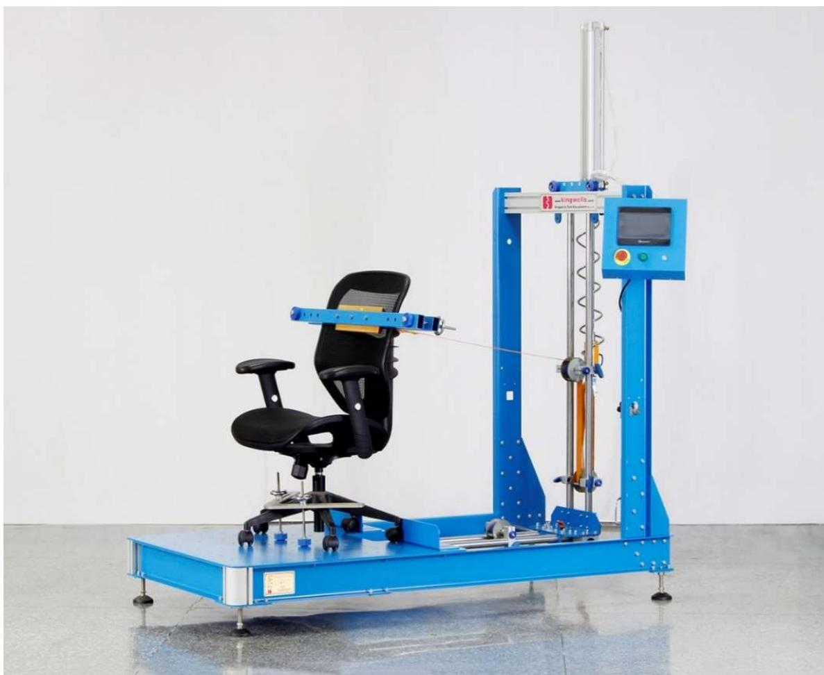
本设备可输出控制力，也可输出控制位移。
